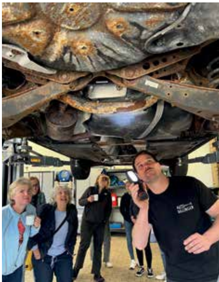
Sebastian Billinger schaut mit der Gruppe das Auto von unten an und erklärt, welche Teile am Auto besonders rostanfällig sind. Foto: Susanne Cimander
